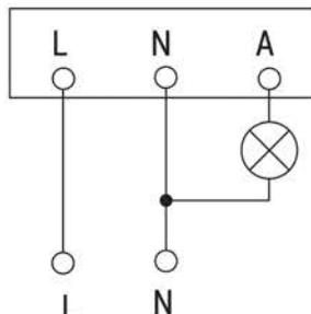
Рисунок 12 – Схема подключения датчика
