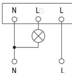
Рисунок 10 – Схема подключения датчиков
