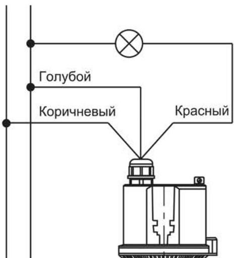
Рисунок 14 – Схема подключения датчика
