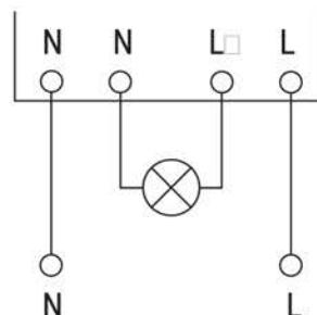
Рисунок 11 – Схема подключения датчика
