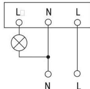
Рисунок 13 – Схема подключения датчика
