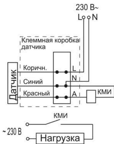
Рисунок 8 – Схема подключения датчиков с контактором КМИ
