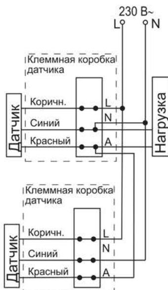
Рисунок 6 – Схема параллельного подключения датчиков движения
