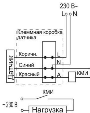
Рисунок 21 – Схема подключения датчика с контактором КМИ
