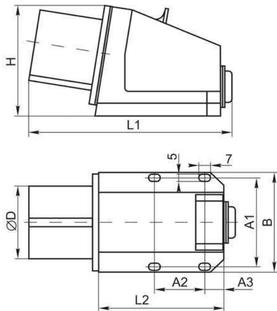
Рисунок 5 – Вводные устройства (Вилки стационарные) ССИ: 513, 514, 515, 523, 524, 525/
