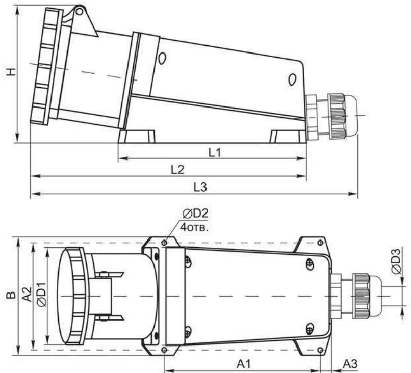
Рисунок 1б – Розетки штепсельные (Розетки штепсельные стационарные) ССИ: 133, 134, 135, 145/
