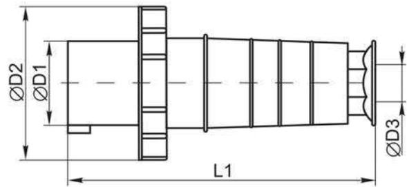
Рисунок 4б – Вилки переносные ССИ: 033, 034, 035, 045/
