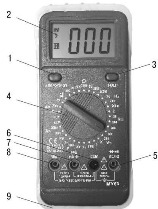
Рисунок 1 – Элементы лицевой панели мультиметров
