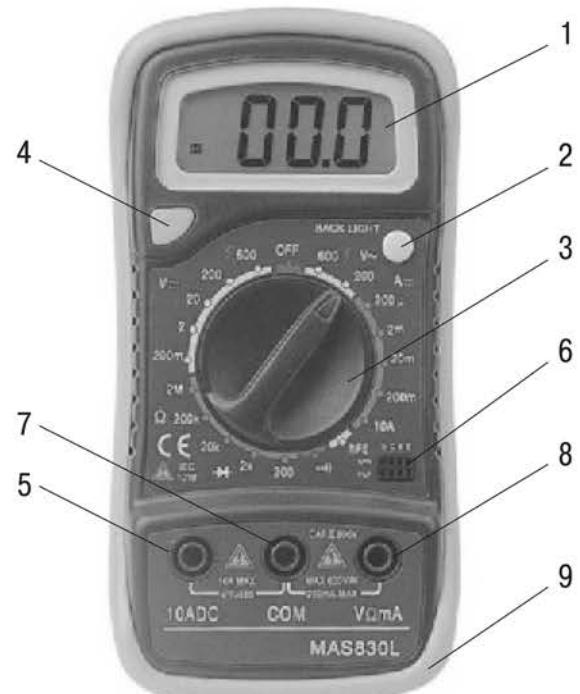
Рисунок 1 – Элементы лицевой панели мультиметров
