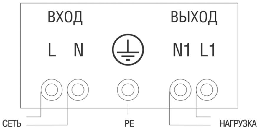
Рис 4. Схема подключения стабилизаторов
