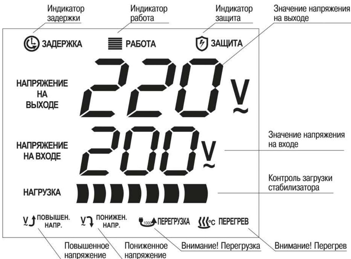
Рис 2. Индикация режимов работы стабилизаторов
