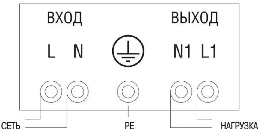
Рис 3. Схема подключения стабилизаторов от 3 до 12 кВА
