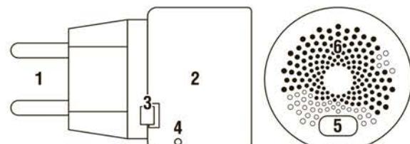
1 – вилка для подключения к сети; 2 – корпус; 3 – фиксатор корпуса; 4 – отверстие кнопки сброса настроек; 5 – кнопка-индикатор; 6 – решетка датчика газа.
