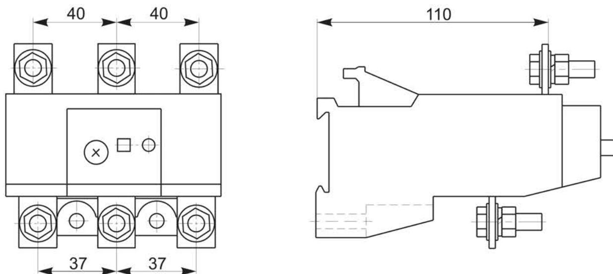
Рисунок 4 – Габаритные, установочные и присоединительные размеры
