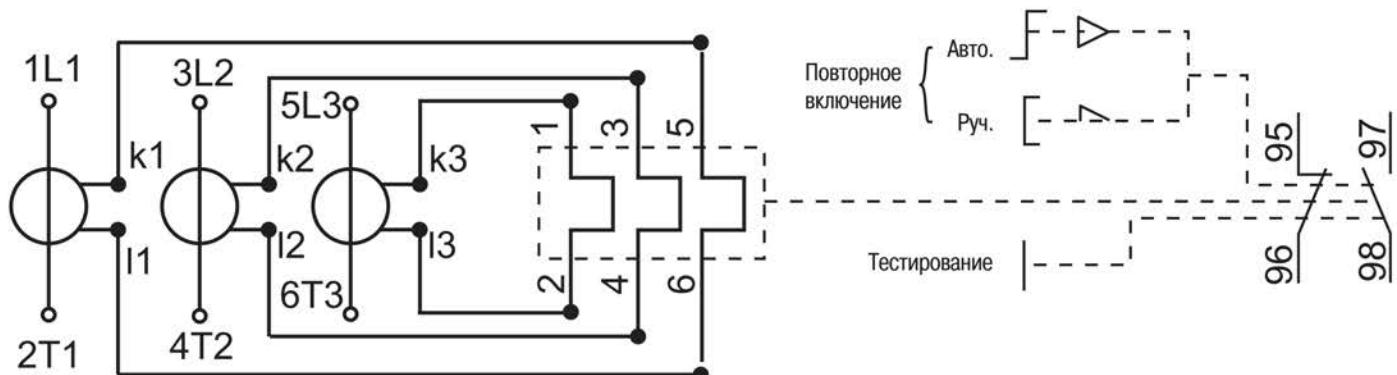
Рисунок 2 – Электрическая схема реле РТИ-6376
