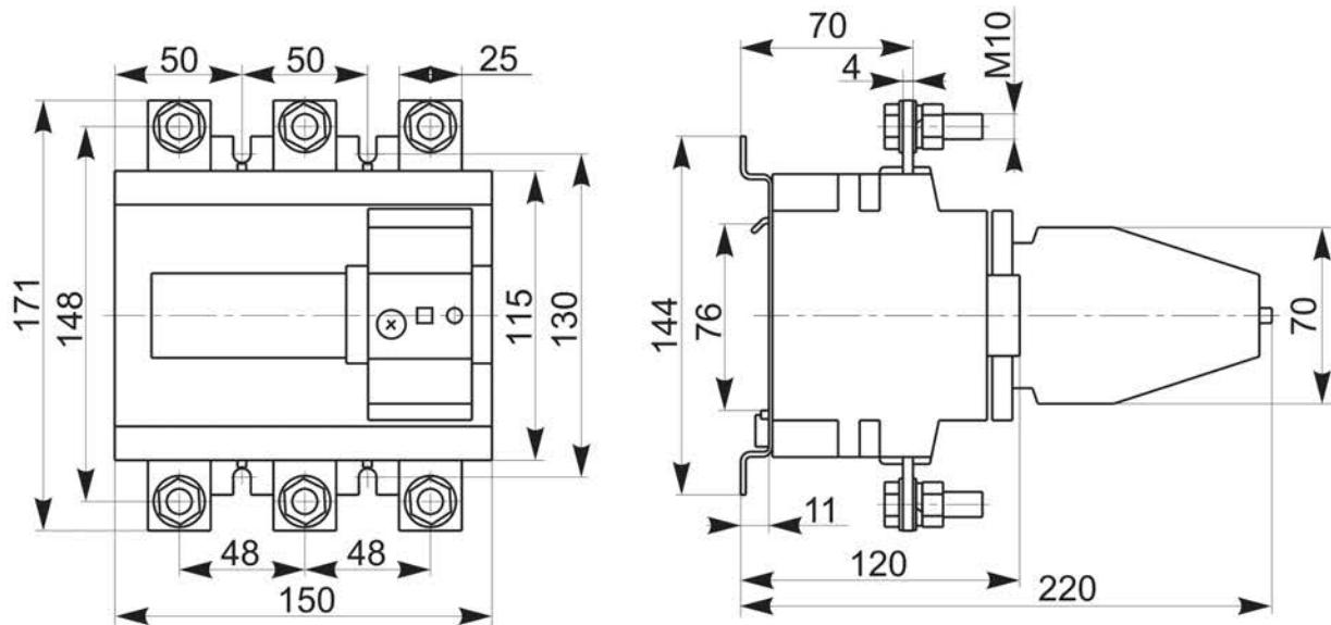
Рисунок 5 – Габаритные, установочные и присоединительные размеры реле РТИ-6376
