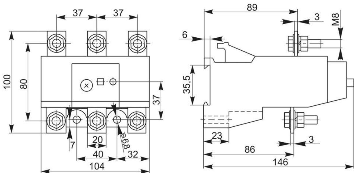
Рисунок 3 – Габаритные, установочные и присоединительные размеры
