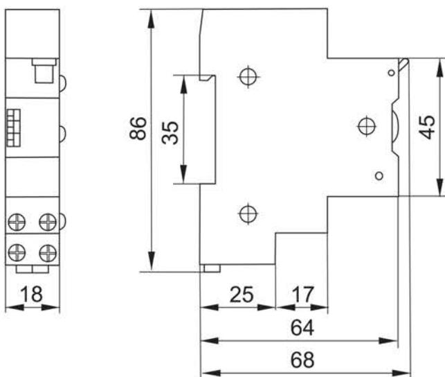
Рисунок 1 – Таймер ТО-47
