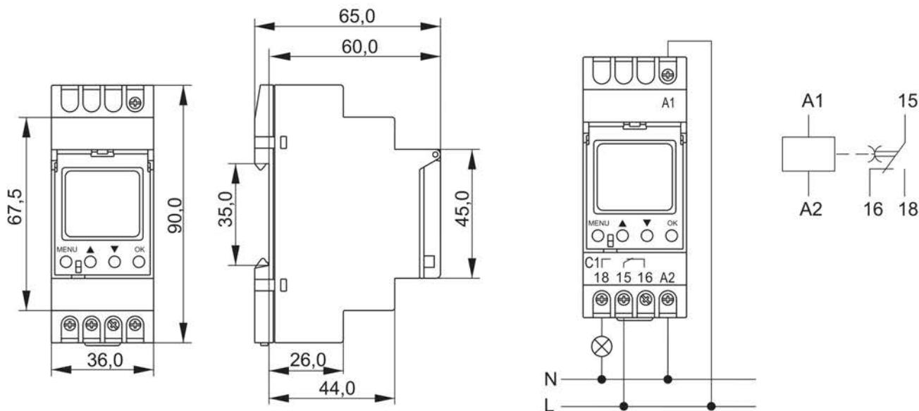
Рисунок 2 – Габаритные и установочные размеры таймера
