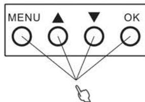
5.8.1 Одновременное нажатие кнопок «MENU», «▲▼» и «OK» в течение 4 секунд приведет к сбросу всех установленных пользователем программ и параметров до заводских настроек.
