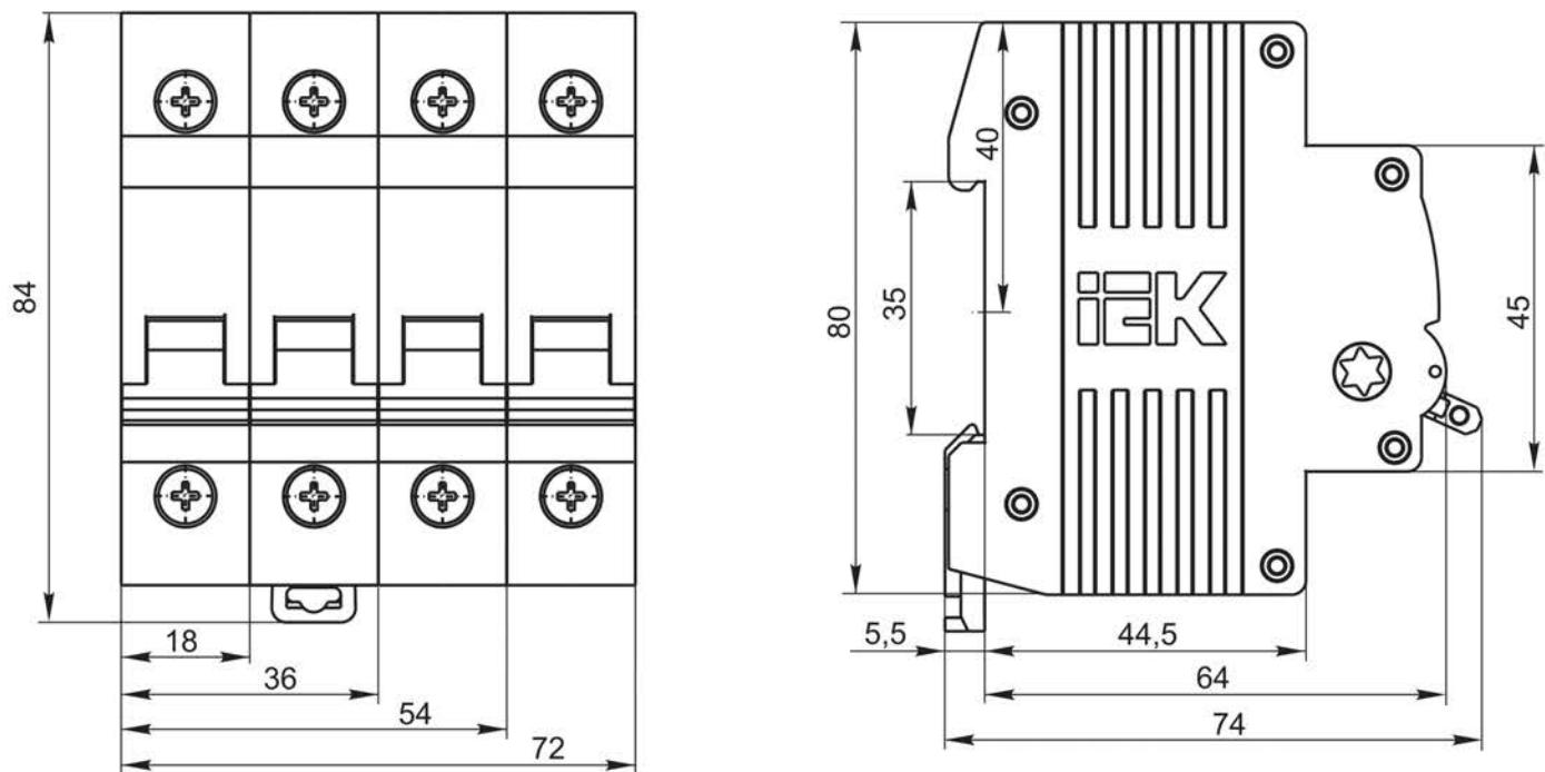
Рисунок 1 – Габаритные и установочные размеры BH-32
