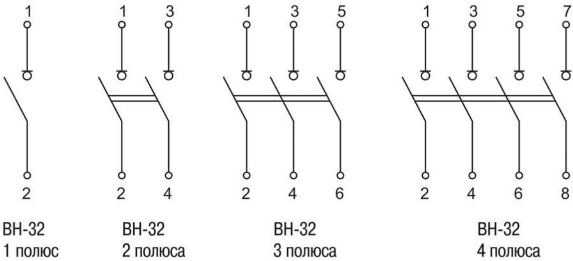
Рисунок 2 – Схемы электрические BH-32
