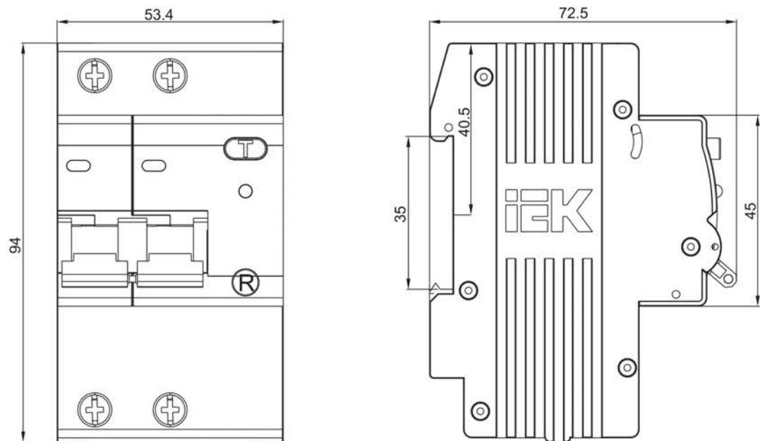
Рисунок 2 – Габаритные размеры АД12М
