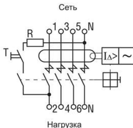
Рисунок 4 – Схема электрическая принципиальная четырехполюсных ВД
