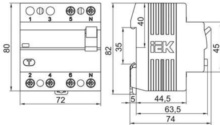
Рисунок 2 – Габаритные и установочные размеры четырехполюсных ВД
