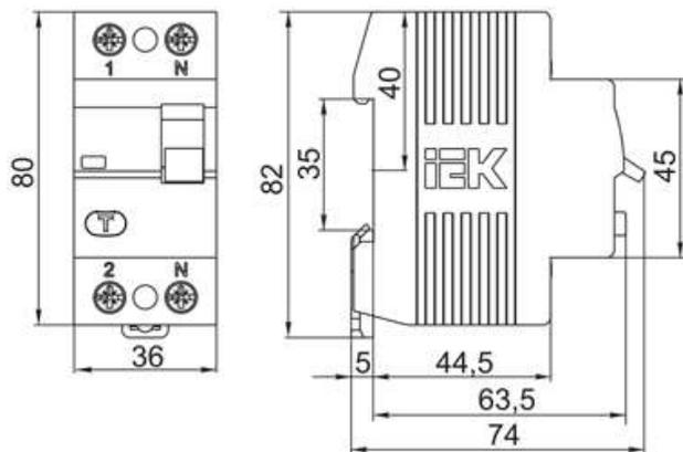
Рисунок 1 – Габаритные и установочные размеры двухполюсных ВД
