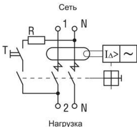
Рисунок 3 – Схема электрическая принципиальная двухполюсных ВД
