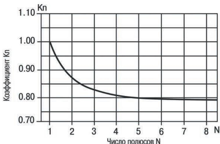
Рисунок 3 – Зависимость коэффициента Kn от числа полюсов
