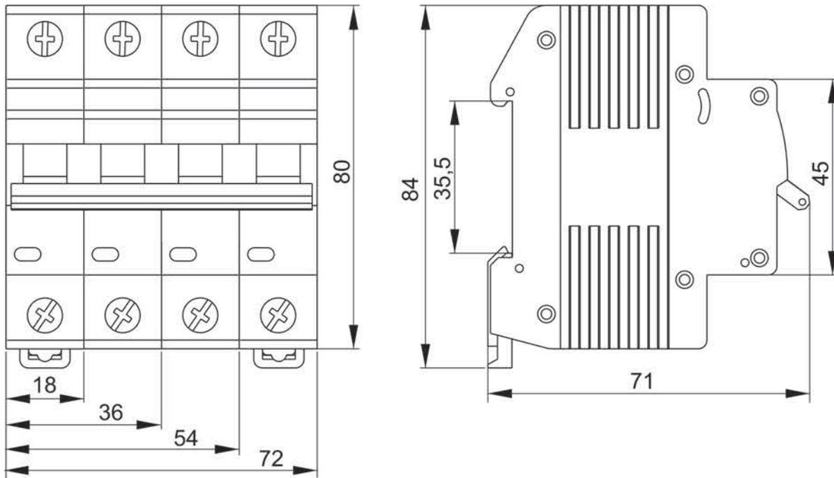
Рисунок 4 – Габаритные и установочные размеры выключателей
