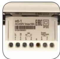
Схема подключения на корпусе изделия
