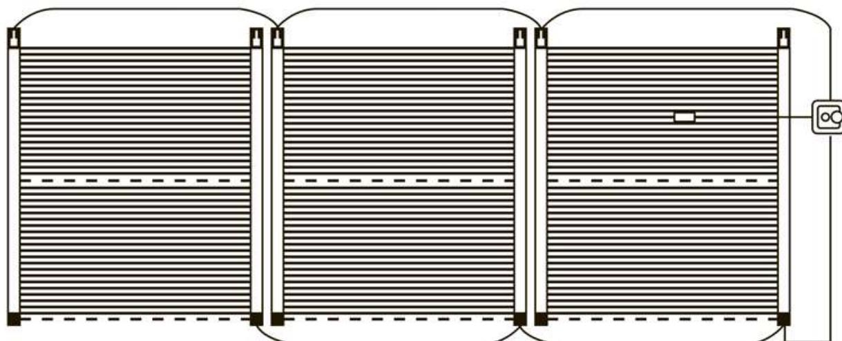
Рисунок 2. Общая схема подключения, в случаях, когда установочные провода проложены непосредственно под напольным покрытием без дополнительной защиты.
