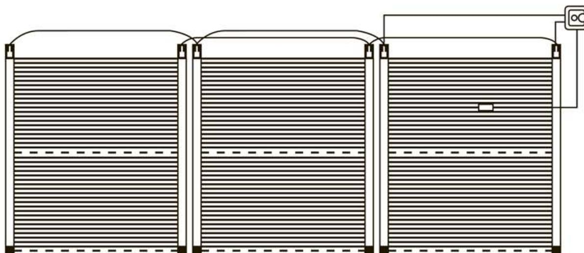
Рисунок 1. Общая схема подключения, в случаях, когда установочные провода проложены под плинтусом, утоплены в прорезях теплоизоляции, или в специальных кабель-каналах, исключающих непосредственное механическое воздействие.
