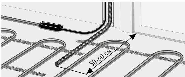
5) После закрепления гофрированной трубы на полу и на стене необходимо убедиться в том, что датчик свободно перемещается внутри трубы. Для этого достаточно частично вытянуть и затем обратно вставить соединительный провод датчика. Такой способ монтажа применяется, чтобы можно было при необходимости легко заменить датчик.
