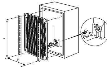
**Регулировка положения монтажных деталей**
