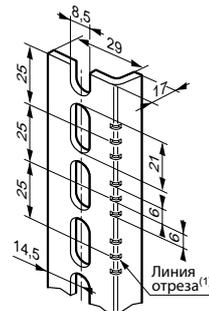
(1) Линия отреза для стоек с шагом 25 мм. Две другие метки обеспечивают длину стоек с кат. № 0 361 50/51/52/53/54/55/56.
