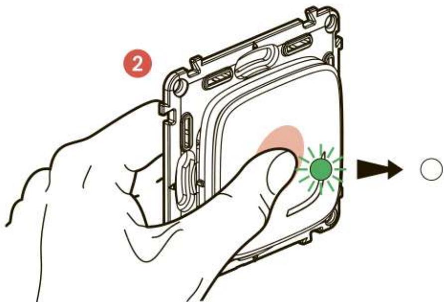
**Кратковременно** нажмите на середину умного беспроводного выключателя, чтобы активировать его. Индикатор замигает зеленым светом и погаснет.
