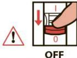
Отключите питание соответствующим автоматическим выключателем.
