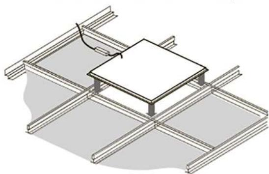
Рис. 1. Монтаж светильника в подвесной потолок типа «Армстронг».
