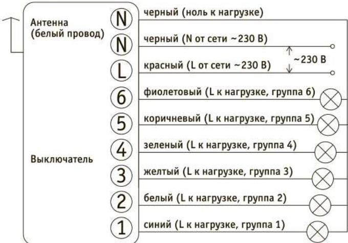
Кнопки «1», «2», «3», «4», «5», «6» на пульте отвечают за включение и выключение соответствующих каналов. Кнопки «ВКЛ», «ВЫКЛ» отключают и включают сразу все каналы.
