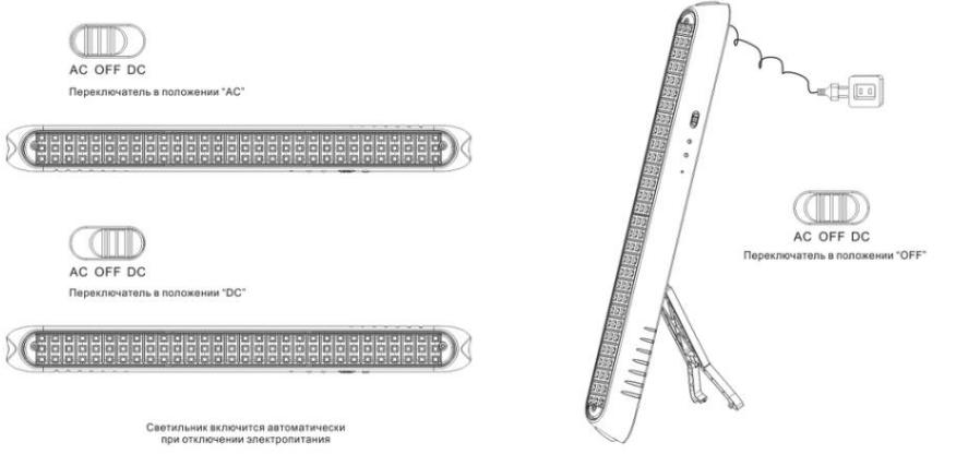
**ВАЖНО:** Пожалуйста, выключите фонарь-лампу (переключатель в положении "OFF") во время перезарядки. Устройство не заряжается в положении переключателя "AC".
