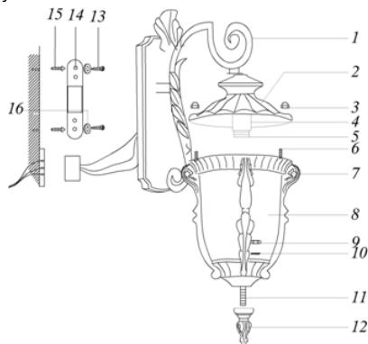
1 – рожок; 2 – верхняя крышка; 3 – декоративная гайка; 4 – ламподержатель; 5 – патрон; 6 – винты; 7 – каркас; 8 – стеклянный рассеиватель; 9 – гайка; 10 – гровер; 11 – полое винтовое крепление; 12 – балансина; 13 – саморезы; 14 – крепежная скоба; 15 – фиксаторы саморезов; 16 – шайба.
