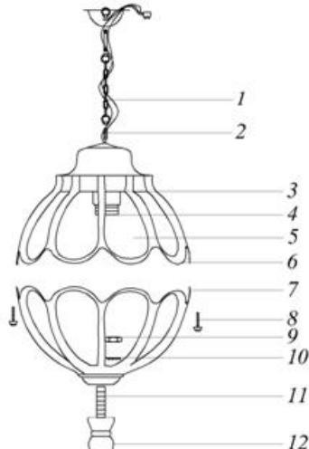
1 – цепь для подвеса; 2 – резьбовой крепеж; 3 – ламподержатель; 4 – патрон для лампы; 5 – рассеиватель; 6 – верхняя крышка; 7 – нижняя часть светильника; 8 - крепежный винт; 9 – гайка; 10 – гровер; 11 – резьбовой крепеж; 12 – декоративная балюсина.
