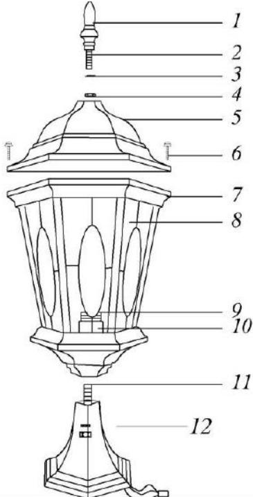
1 – балансина; 2 – резьбовое крепление; 3 – гровер; 4 – гайка; 5 – верхняя крышка; 6 – винты; 7 – каркас; 8 – стеклянный рассеиватель; 9 – патрон; 10 – ламподержатель; 11 – резьбовое крепление; 12 – постамент.
