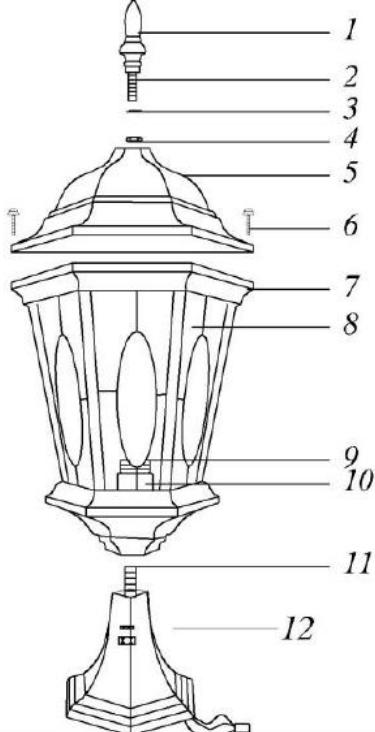
1 – балюсина; 2 – резьбовое крепление; 3 – гровер; 4 – гайка; 5 – верхняя крышка; 6 – винты; 7 – каркас; 8 – стеклянный рассеиватель; 9 – патрон; 10 – ламподержатель; 11 – резьбовое крепление; 12 – постамент.
