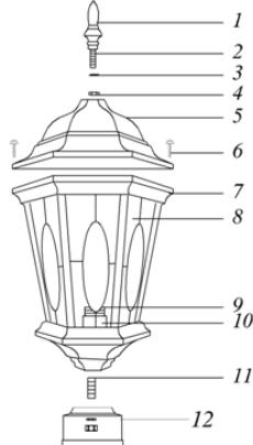
1 – балюсина; 2 – резьбовое крепление; 3 – гровер; 4 – гайка; 5 – верхняя крышка; 6 – винты; 7 – каркас; 8 – стеклянный рассеиватель; 9 – патрон; 10 – ламподержатель; 11 – резьбовое крепление; 12 – постамент.
