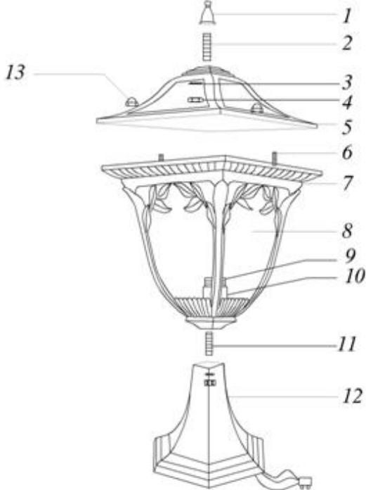
1 – балюсина; 2 – резьбовое крепление; 3 – гровер; 4 – гайка; 5 – винты; 6 – верхняя крышка; 7 – каркас; 8 – стеклянный рассеиватель; 9 – патрон; 10 – ламподержатель; 11 – резьбовое крепление; 12 – постамент.
