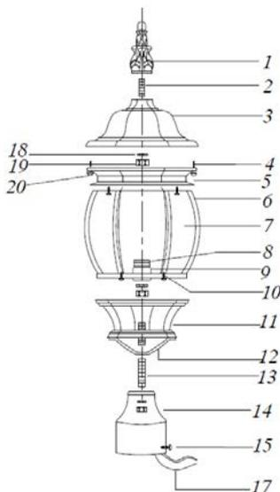
1 – балясина; 2 – резьбовое крепление; 3 – верхняя крышка; 4 – резьбовое крепление; 5 – верхняя рамка; 6 – каркас; 7 – стеклянный рассеиватель; 8 – патрон; 9 – ламподержатель; 10 – винты; 11 – нижняя рамка; 12 – нижняя крышка; 13 – резьбовое крепление; 14 – постамент; 15 – винт; 17 – провод защитного заземления; 18 – гровер; 19 – гайка; 20 – винт.
