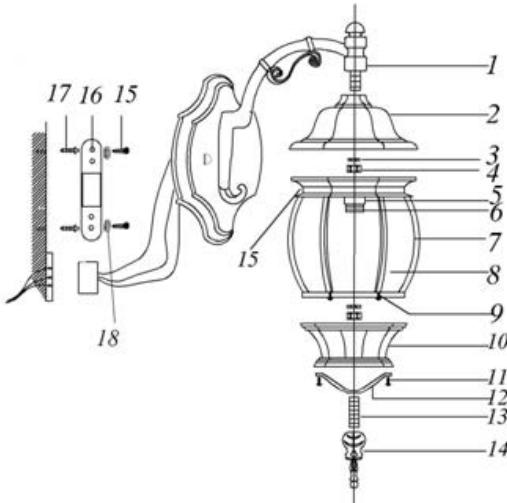
1 – основание; 2 – крышка; 3 – гровер; 4 –гайка; 5 – ламподержатель; 6 – патрон; 7 – каркас; 8 – стеклянный рассеиватель; 9 – винты; 10 – нижняя крышка; 11 – винты; 12 – декоративное крепление; 13 – полое винтовое крепление; 14 – балансина; 15 – саморезы; 16 – декоративная скоба; 17 – фиксатор саморезов; 18 - шайба.
