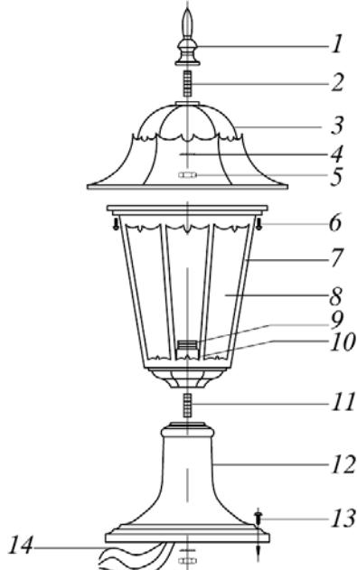
1 – балюсина; 2 – большое резьбовое крепление; 3 – верхняя крышка; 4 – гровер; 5 – гайка; 6 – винты; 7 – каркас; 8 – стеклянный рассеиватель; 9 – патрон; 10 – ламподержатель; 11 – малое резьбовое крепление; 12 – постамент; 13 – винт; 14 – провод защитного заземления.
