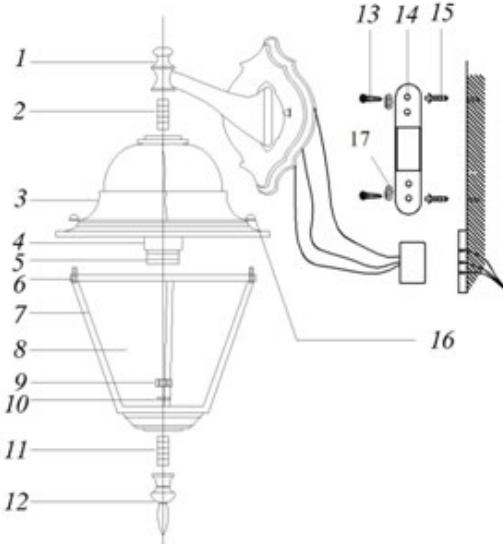
1 – балансина; 2 – малое резьбовое крепление; 3 – крышка; 4 – ламподержатель; 5 – патрон; 6 – винты; 7 – каркас; 8 – стеклянный рассеиватель; 9 – гайка; 10 – гровер; 11 – большое резьбовое крепление; 12 – основание; 13 – саморезы; 14 – крепежная скоба; 15 – фиксаторы саморезов; 16 – шайба.
