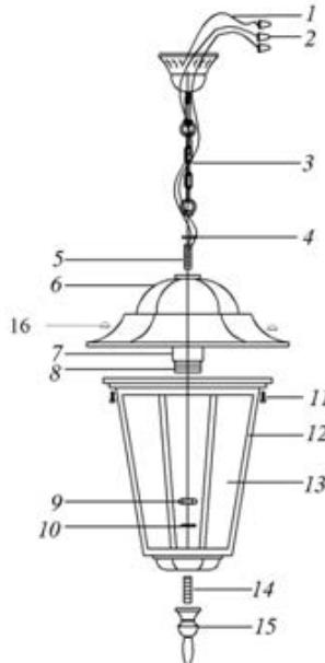
1 – провод заземления; 2 – провода питания; 3, 4 – цепь подвеса; 5 – малое резьбовое крепление; 6 – алюминиевая крышка; 7 – ламподержатель; 8 – керамический патрон; 9 – гайка; 10 – гровер; 11 – крепежные винты; 12 – металлический каркас; 13 – стеклянный рассеиватель; 14 – большое резьбовое крепление; 15 – декоративная балесина.
