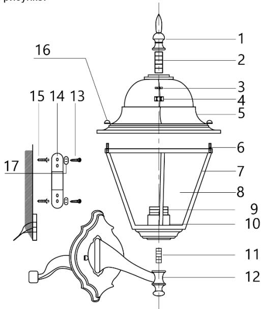
1 – балюсина; 2 – большое резьбовое крепление; 3 – гровер; 4 – гайка; 5 – крышка; 6 – винты; 7 – каркас; 8 – стеклянный рассеиватель; 9 – патрон; 10 – лампадодержатель; 11 – малое резьбовое крепление; 12 – основание; 13 – саморезы; 14 – крепежная скоба; 15 – крепежные отверстия; 16 – декоративные гайки; 17 – прокладка.
