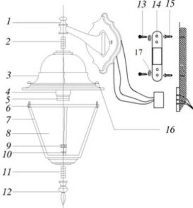
1 – баласина; 2 – малое резьбовое крепление; 3 – крышка; 4 – ламподержатель; 5 – патрон; 6 – винты; 7 – каркас; 8 – стеклянный рассеиватель; 9 – гайка; 10 – гровер; 11 – большое резьбовое крепление; 12 – основание; 13 – саморезы; 14 – крепежная скоба; 15 – фиксаторы саморезов; 16 – шайба.
