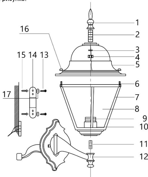
1 – балясина; 2 – большое резьбовое крепление; 3 – гровер; 4 – гайка; 5 – крышка; 6 – винты; 7 – каркас; 8 – стеклянный рассеиватель; 9 – патрон; 10 – ламподержатель; 11 – малое резьбовое крепление; 12 – основание; 13 – саморезы; 14 – крепежная скоба; 15 – крепежные отверстия; 16 – декоративные гайки; 17 – прокладка.
