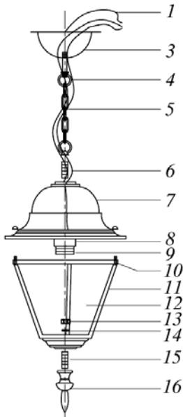
1 – провод заземления; 2 – провода питания; 3 – чаша для крепления; 4 – крепежное кольцо; 5 – цепь подвеса; 6 – малое резьбовое крепление; 7 – верхняя крышка; 8 – ламподержатель; 9 – патрон; 10 – винты; 11 – каркас; 12 – стеклянный рассеиватель; 13 – гайка; 14 – гровер; 15 – большое резьбовое крепление; 16 - балансина.
