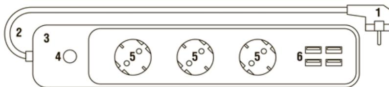
1 – вилка для подключения к сети; 2 – кабель питания 1,5 метра; 3 – корпус; 4 – кнопка включения/выключения и светодиодный индикатор; 5 – розетка для подключения нагрузки; 6 – USB-разъемы
