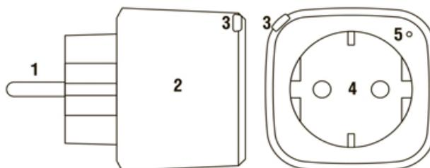
1 – вилка для подключения к сети; 2 – корпус; 3 – кнопка включения/выключения; 4 – розетка для подключения нагрузки; 5 – светодиодный индикатор.
