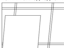
1 Извлечь ячейку потолка для монтажа панели AL2113.
