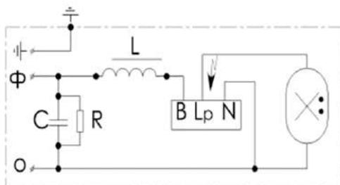
Рисунок 3 – Схема подключения к сети светильников ЖКУ21/ГКУ21 «Гелиос»
