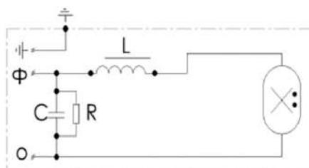
Рисунок 4 – Схема подключения к сети светильников РКУ21 «Гелиос»
