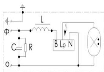
Рисунок 4 – Схема подключения к сети светильников ЖКУ15/ГКУ15
