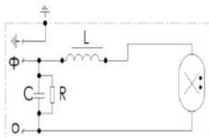
Рисунок 5 – Схема подключения к сети светильников РКУ15
