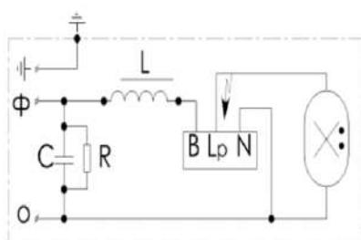
Рисунок 3 – Схема подключения к сети
