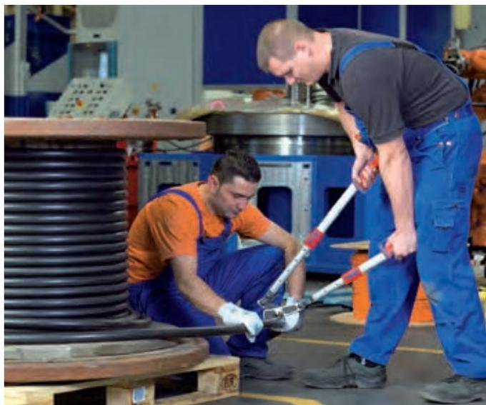
Ножницы для резки кабеля с регулируемыми по длине и углу раздвижными ручками.
