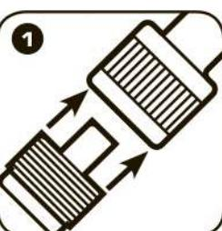
1. Установите помпу по возможности на ровной, плоской поверхности. Такое положение обеспечит устойчивость насоса во время работы. Присоедините рукав РВД к клапану на исполняющем инструменте через БРС.
