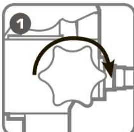
Поверните дросельный винт в положение «Закрыть»
