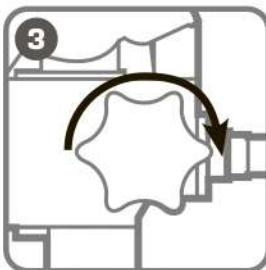
**Поверните винт сброса давления в положение «Закрыть»**
