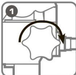
Поверните дросельный винт в положение «Закрыть»
