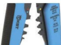
Предназначен для опрессовки изолированных гильз и наконечников сечением от 0,5 до 6 мм<sup>2</sup> (НКИ, НИК, НВИ, ГСИ, НШКИ, НШПИ, изолированных разъемов) и неизолированных гильз и наконечников сечением от 0,5 до 6 мм<sup>2</sup> (ГМЛ, ГМЛ(о), ТМ, ТМЛ, ТМЛ(о), автоклемм)
