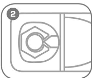
**Создайте давление помпой, разрежьте гайку**
